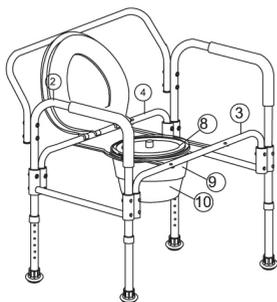
Поставьте насадку на ведро ( 8 x 1), ведро (9 x 1) и защиту от брызг ( 10 x 1) в отверстие, закрепленное на трубках кронштейнах.
