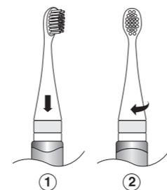
Установите насадку на рукоятку совмещая направляющие на насадке и рукоятке. Зафиксируйте насадку на рукоятке, повернув ее до упора по часовой стреле, как показано на рисунке. Для того чтобы снять насадку, необходимо проделать те же действия в обратном порядке.
