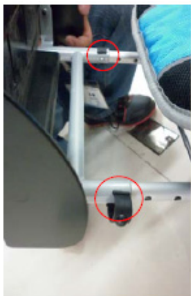
Установите пластиковые защитные части. Подножки установлены.
