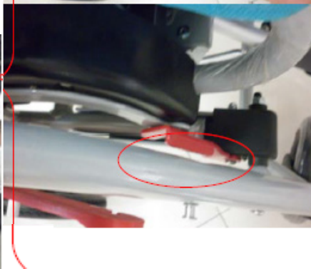
Защелкните красные фиксаторы на шурупы.
