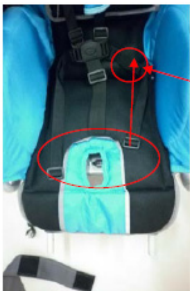
Просуньте ремень через нижние отверстия и протяните к средним отверстиям.
